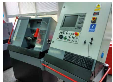
Maszyna Emco po modernizacji z TNC 620
